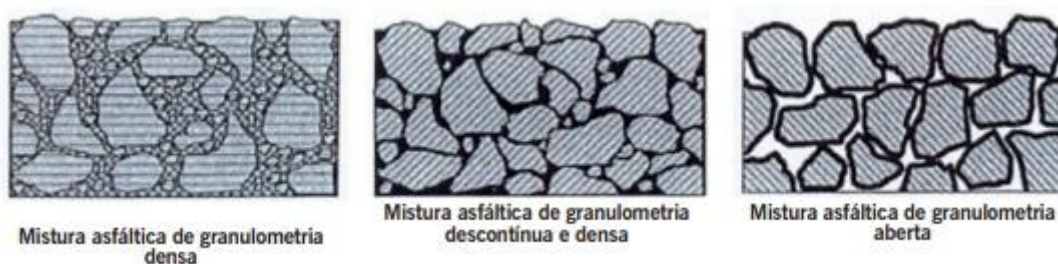
Figura 2.11 - Exemplos dos tipos de misturas a quente. Fonte: Ceratti, Bernucci e Soares, 2015.
