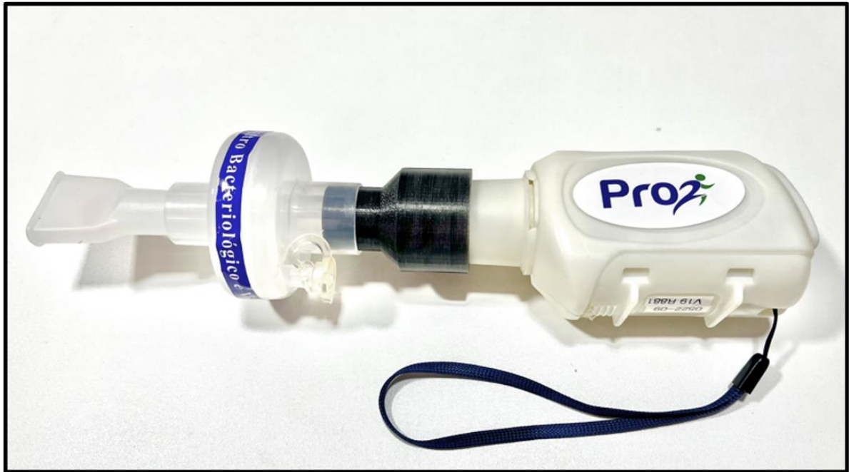
Figura 4. PrO2 preparado para a execução do Test of Incremental Respiratory Endurance (TIRE) com a adaptação personalizada entre o aparelho e o filtro bacteriológico.
