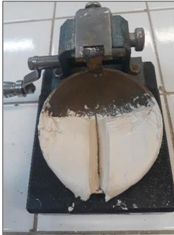
Figura 34 – Aparelho de Casa Grande, mostrando o fechamento do sulco
