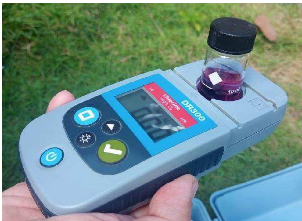
Figura 9 – Análise de Cloro Residual Livre
