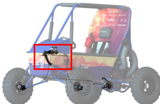
Figura 16 – Montagem do veículo com linhas rígidas destacadas
