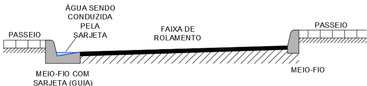
Figura 9 - Seção de via com representação de guia
