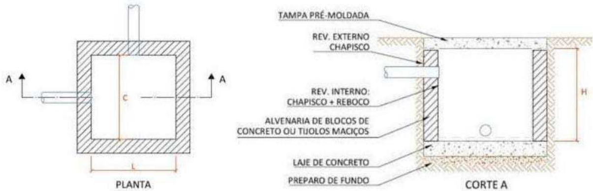
Figura 12 - Modelo de caixa hidráulica
