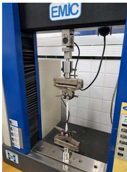
Figura 22 – Ensaio de tração na máquina universal EMIC DL-2000
