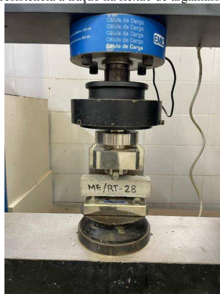
Figura 27 - Ensaio de resistência à tração na flexão de argamassa de projeção comercial
