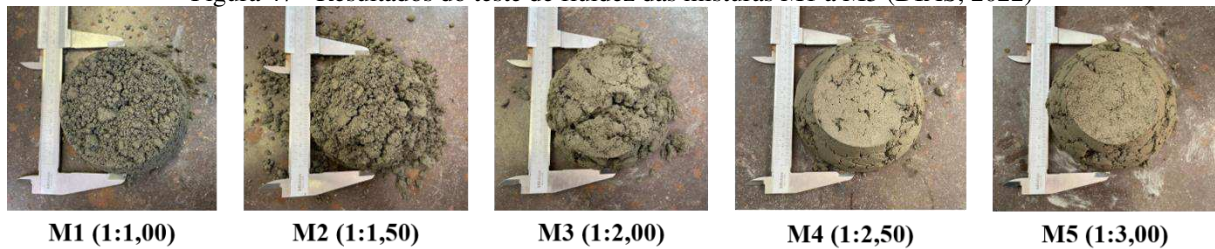
Figura 47 - Resultados do teste de fluidez das misturas M1 a M5 (DIAS, 2022)
