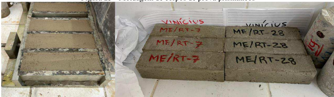
Figura 25 - Moldagem de corpos de prova prismáticos
