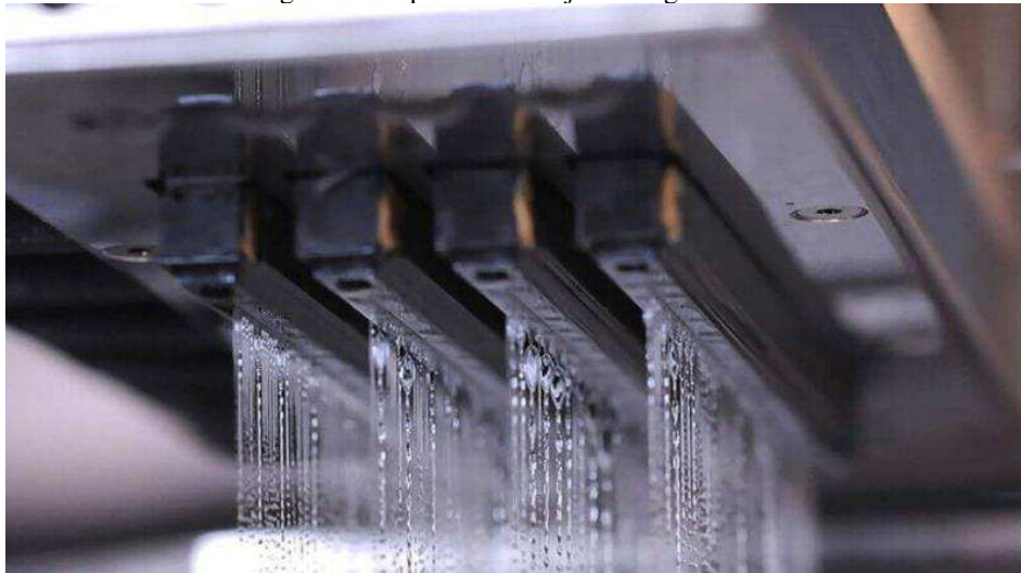
Figura 4 - Impressão 3D à jato de aglutinante
