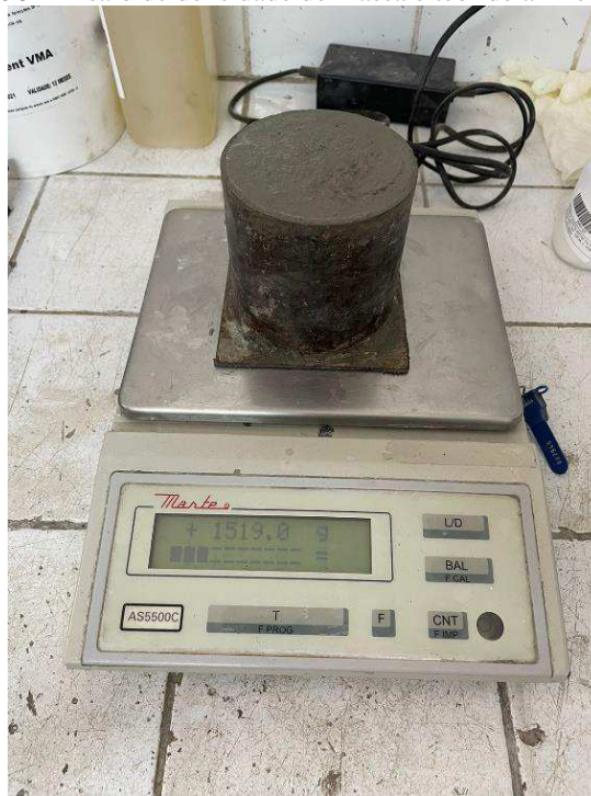
Figura 38 - Ensaio de densidade de massa e teor de ar incorporado
