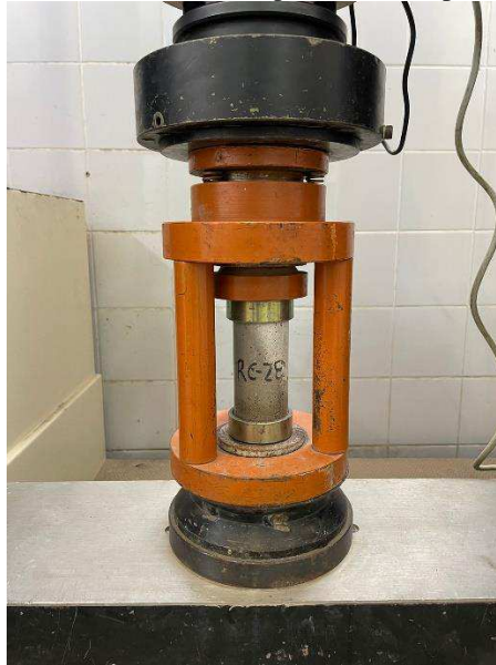
Figura 26 - Ensaio de resistência à compressão de corpo de prova cilíndrico
