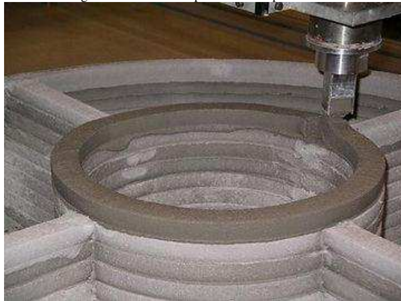
Figura 7 - Concreto impresso em 3D por extrusão
