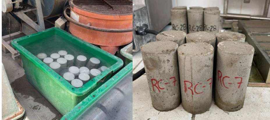
Figura 24 - Tanque de cura e corpos de prova cilíndricos
