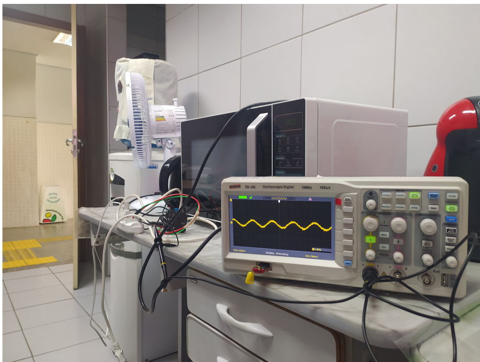
Figura 17 – Medição do ventilador e do micro-ondas em seu local de funcionamento.
