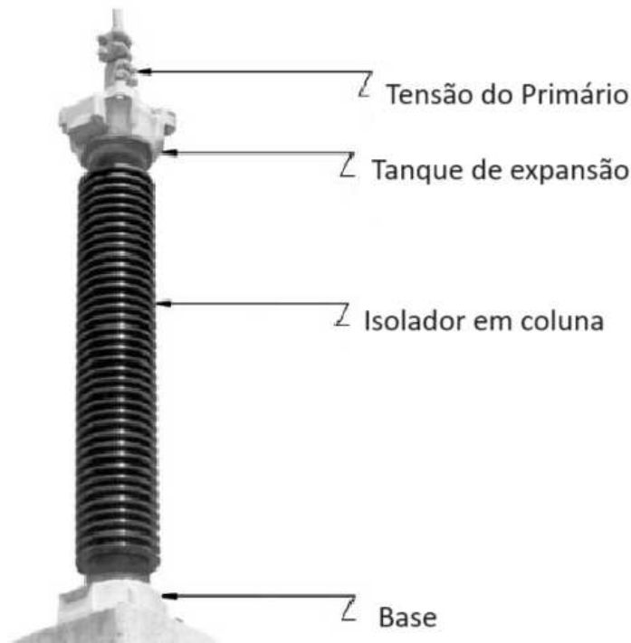
Figura 3 – Transformador de Potencial.
