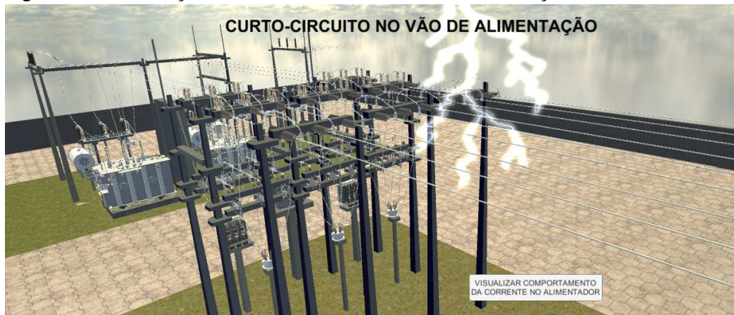
Figura 19 – Simulação de curto-circuito no vão de alimentação.
