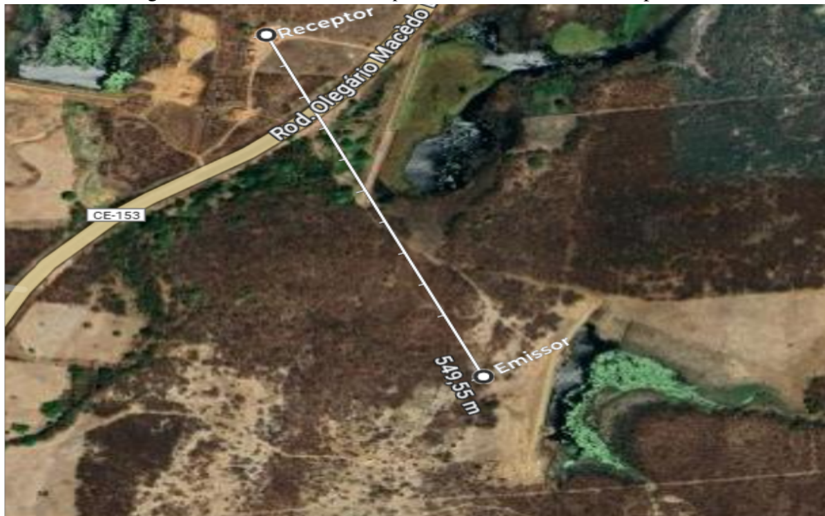
Figura 17 – Distância entre Esp Wroom 32 emissora e receptora.
