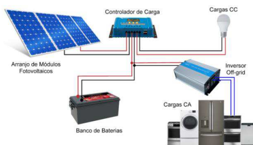
Figura 2: Esquema de funcionamento do Sistema Fotovoltaico (SFV).
