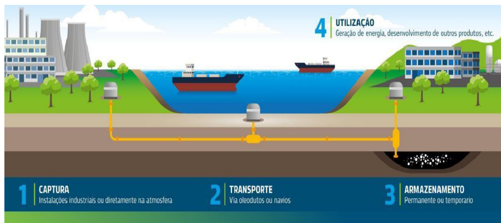
Figura 6 – Etapas do Sistema de Captura, Transporte e Armazenamento de CO 2 .
