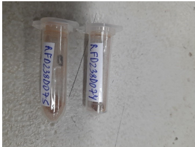
Figura 29 – Sólidos coletados do fenômeno de CR para análise de DRX e de FTIR
