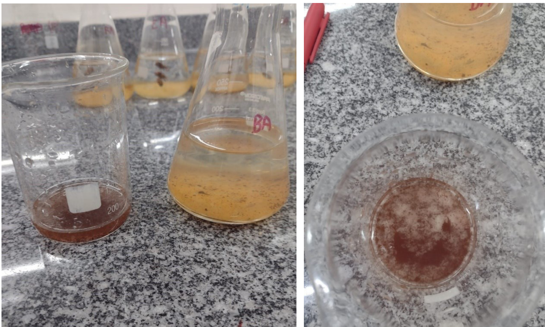
Figura 11 - Produto de corrosão de aço carbono
