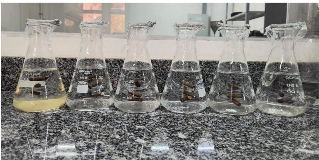
Figura 9 - CP's de Cobre após exposição de 35 dias (840 h)
