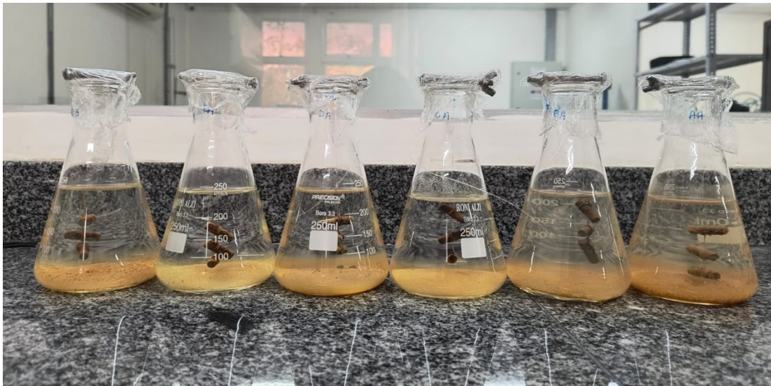
Figura 10 - CP's de Aço carbono após exposição de 35 dias (840 h)
