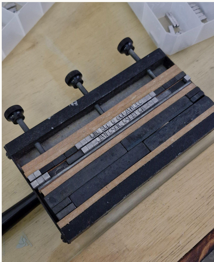
Figura 42 - Matriz com tipos móveis pronta. Fonte: Produzido pela autora.
