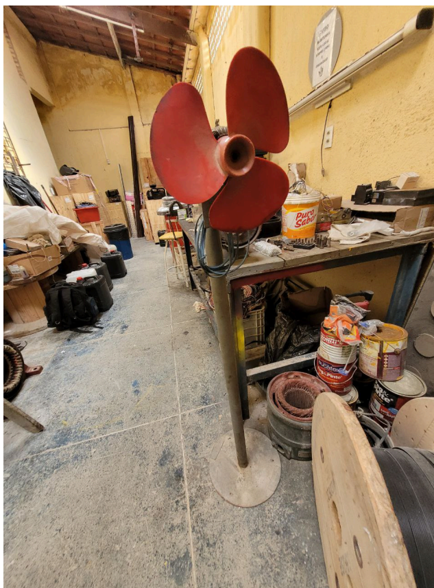
Figura 45 – Ventilador vertical feito de peças de elevador
