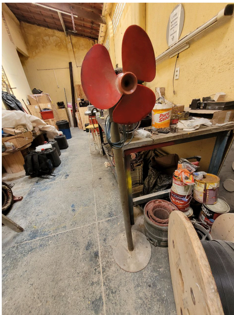
Figura 11 – Ventilador vertical feito de peças de elevador
