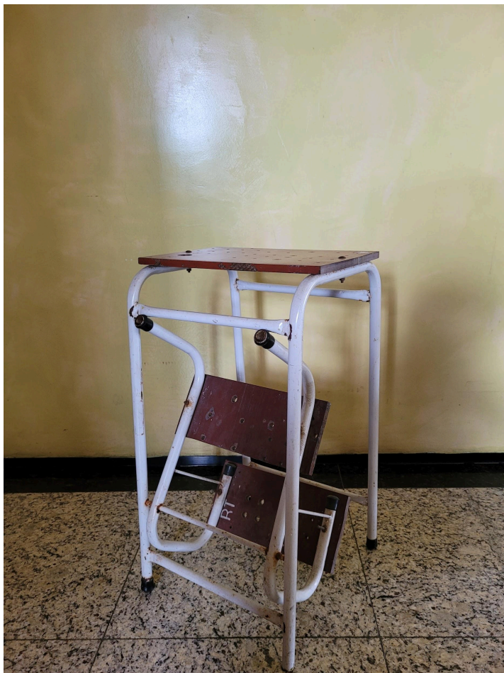
Figura 12 – Escada feita de material isolante advindo de maquinário pesado
