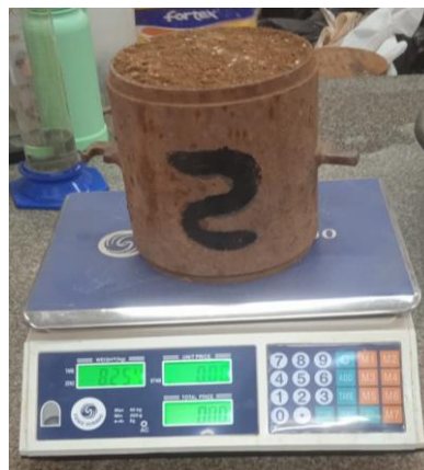
Figura 34 – Pesagem do cilindro e material escarificado.
