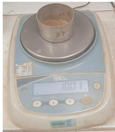
Figura 35 – Amostra de 10 g para ser colocada no picnômetro.
