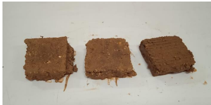
Figura 40 – Corpos de prova após o ensaio de cisalhamento.
