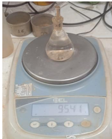
Figura 37 – Pesagem do picnômetro com água destilada.
