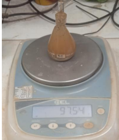
Figura 36 – Pesagem do picnômetro com a amostra e água destilada.
