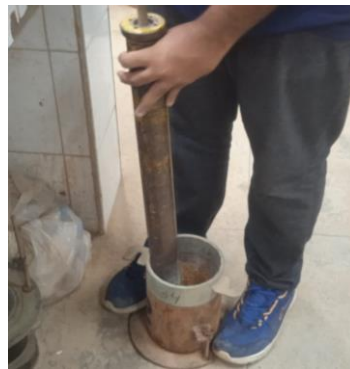
Figura 33 – Compactação em cinco camadas.
