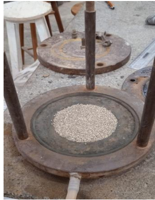
Figura 38 – Camada de material arenoso na base do permeâmetro.
