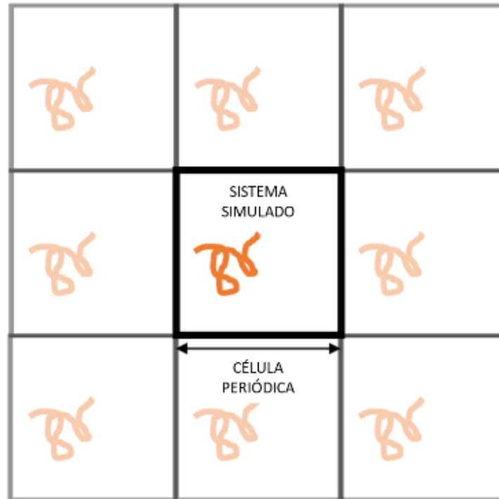
Figura 2 - Representação das condições de contorno periódicas para um sistema em duas dimensões.
