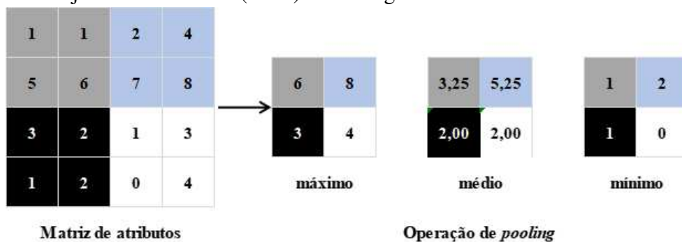
Figura 6 – Representação da operação de pooling com valores máximo, médio e mínimo com uma janela de tamanho (2 \times 2) e stride igual a 2.
