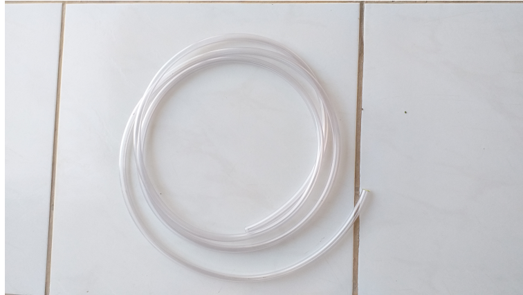
Figura 18 – Figura do magueira de conexão entre as calhas.
