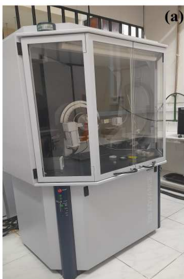
Figura 18 – (a) Difratômetro modelo Advanced D8 da Bruker e (b) porta-amostras fixo.
