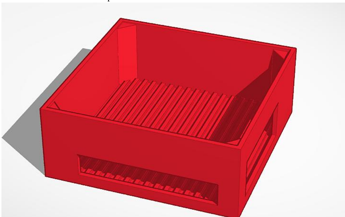
Figura 6 – Protótipo do gabinete desenvolvido no TinkerCad para acomodar os componentes de hardware. Posteriormente impresso em 3D
