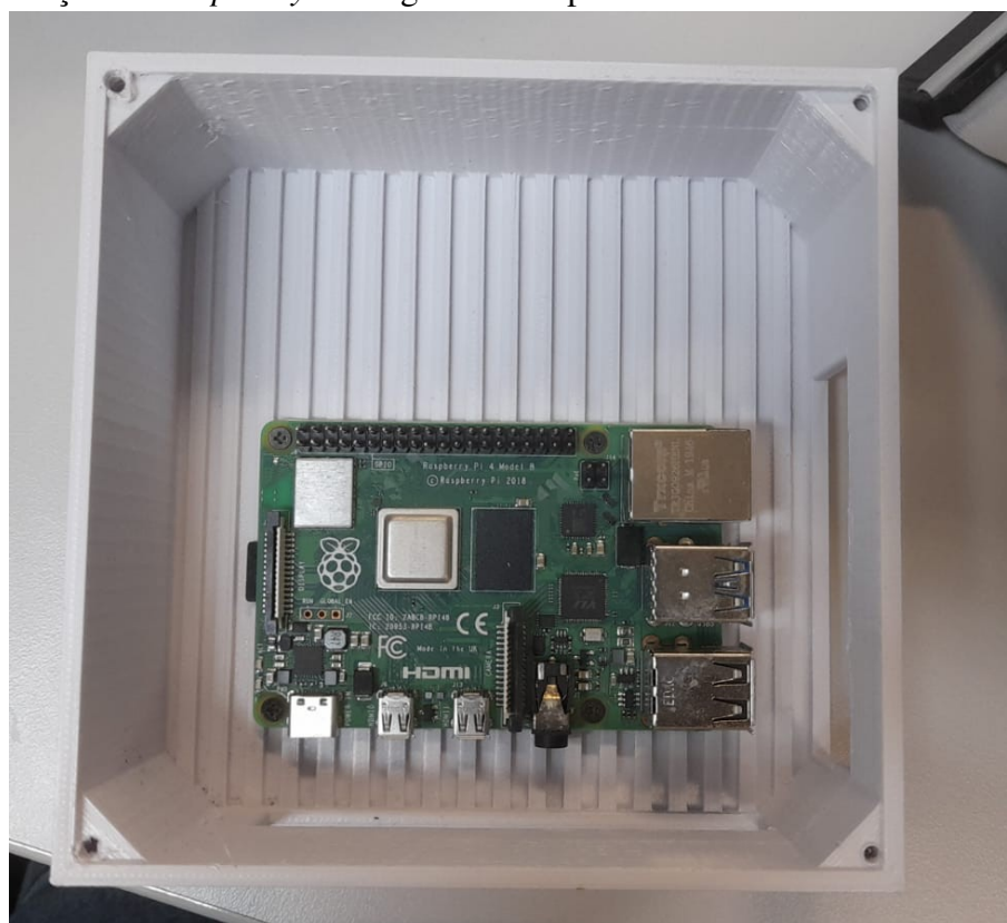
Figura 7 – Fixação do Raspberry Pi no gabinete impresso em 3D.
