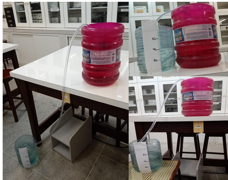
Figura 9 – Experimentos usando a mangueira de diâmetro maior.
