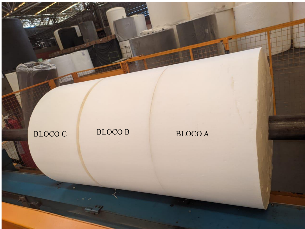
Imagem 2 – Os 3 blocos de teste sendo laminados
