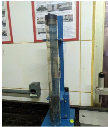
Imagem 6 – Resiliômetro usado para coletar a resiliência das amostras de espuma
