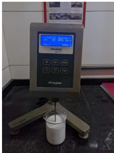
Imagem 7 – O viscosímetro rotacional usado na análise da viscosidade
