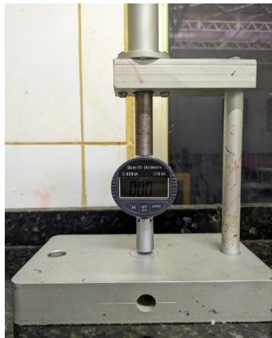
Imagem 5 – Durômetro Shore 00 usado para analisar a dureza das amostras de espuma
