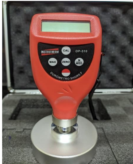
Imagem 4 – Durômetro Shore F usado para analisar a dureza das amostras de espuma
