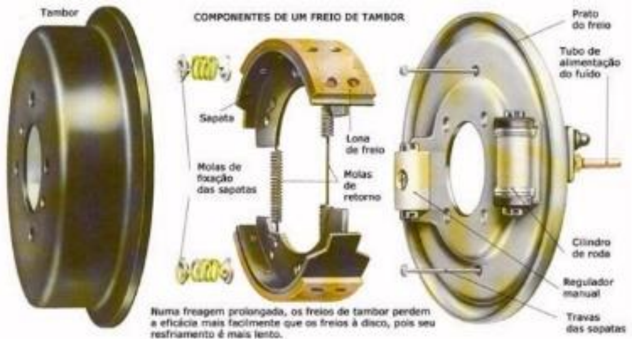
Figura 2 - Componentes de um freio a tambor
