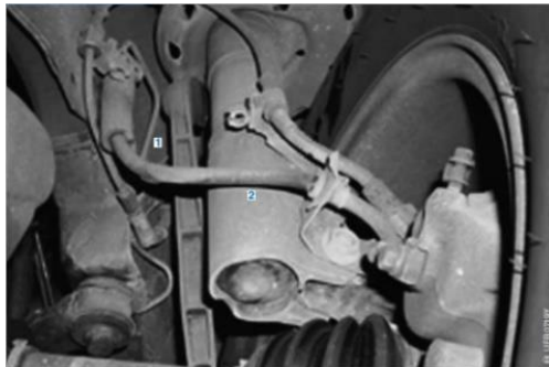
Figura 18 - Tubulações rígidas e mangueiras
