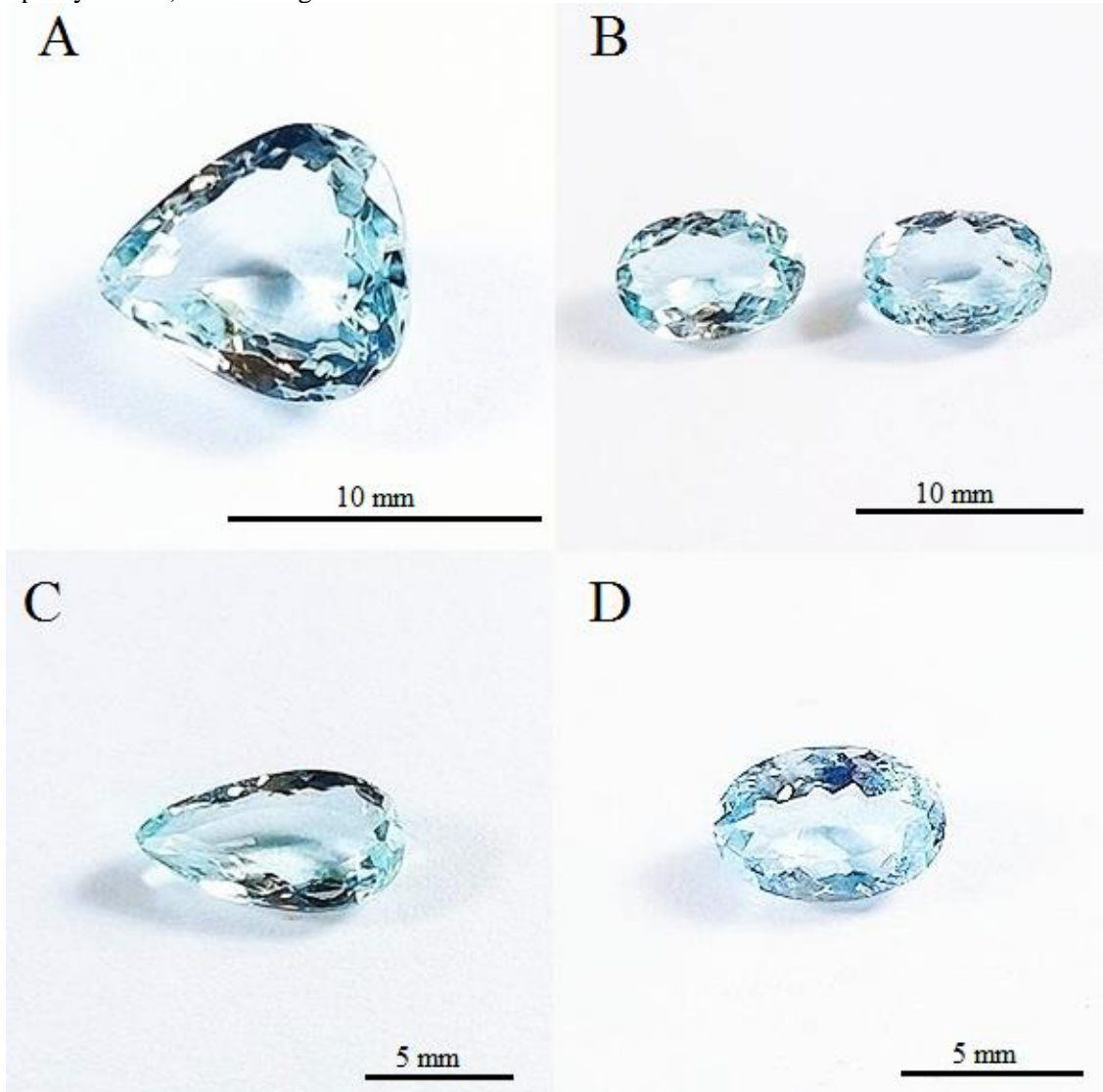
Figura 14: Águas-marinhas do Distrito Pegmatítico Solonópole-Quixeramobim analisadas (amostras da esquerda para a direita). A) Água-marinha (Cyan 2) com as seguintes dimensões: 10.00 x 8.99 x 5.04 mm. B) Água-marinha (Deep Sky Blue 2), com as seguintes dimensões: 8.10 x 5.52 x 3.41 mm e Água-marinha (Deep Sky Blue 1) com as seguintes dimensões: 8.14 x 5.52 x 3.11 mm. C) Água-marinha (Deep Sky Blue 1) com as seguintes dimensões: 8.78 x 4.49 x 2.61 mm. D) Água-marinha (Deep Sky Blue 3) com as seguintes dimensões: 6.38 x 4.20 x 2.65 mm.
