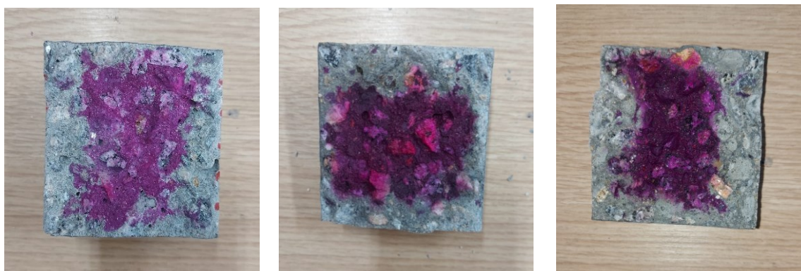
Figura M9 – Profundidades de carbonatação para a amostra 5CO1 ao final do 5º, 9º e 12º ciclos
