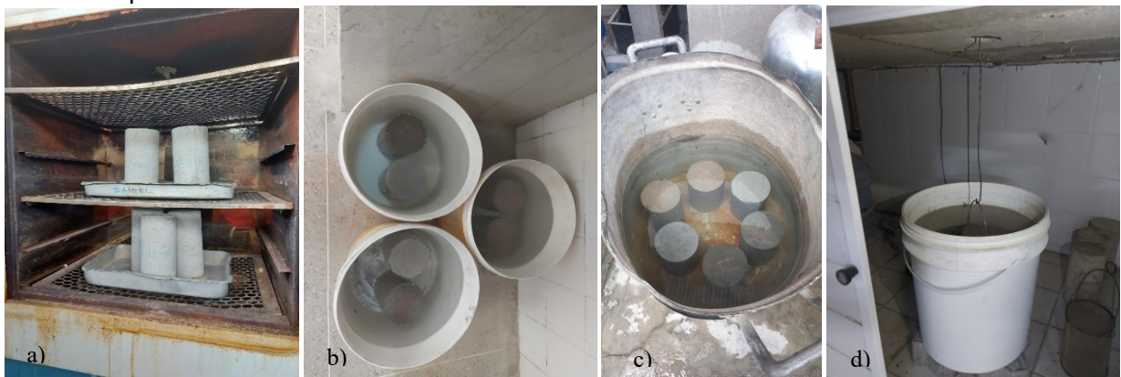
Figura 13 - Procedimento para determinação da absorção de água por imersão, índice de vazios e massa específica
