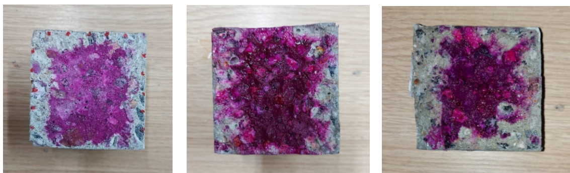
Figura M9 – Profundidades de carbonatação para a amostra 5CO1 ao final do 5º, 9º e 12º ciclos
