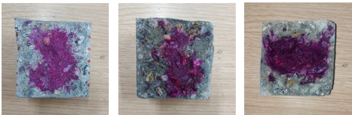
Figura M7 – Profundidades de carbonatação para a amostra 4AC1 ao final do 5º, 9º e 12º ciclos
