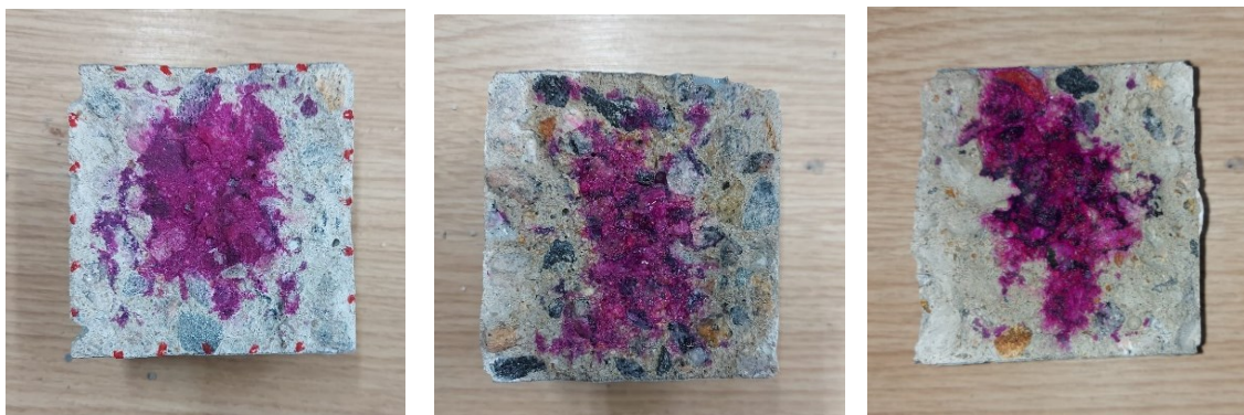
Figura M1 – Profundidades de carbonatação para a amostra 3CO1 ao final do 5º, 9º e 12º ciclos
