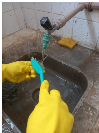
Figura A4 - Remoção dos óxidos com escova
