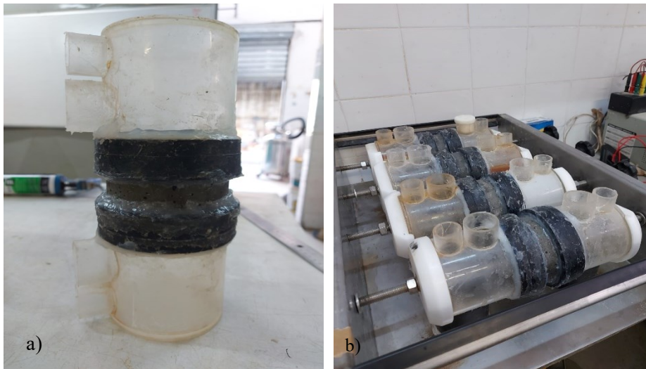
Figura 11 - Ensaio para determinação da resistência à penetração de cloretos
