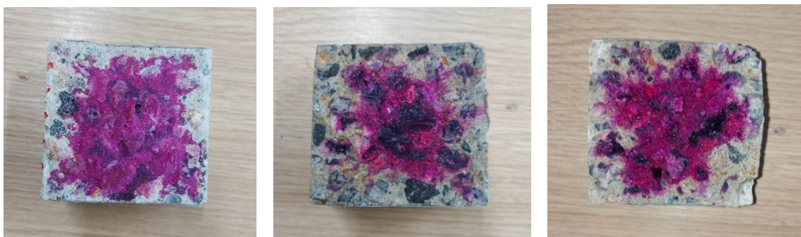
Figura M4 – Profundidades de carbonatação para a amostra 3AC2 ao final do 5º, 9º e 12º ciclos
