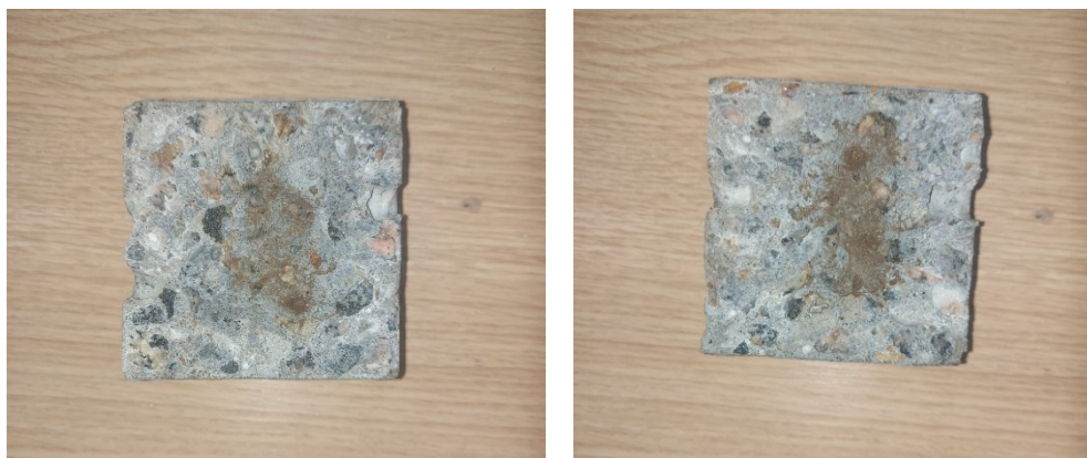
Figura L6 – Profundidades de penetração de cloretos para as amostras 5AC1 e 5AC2
