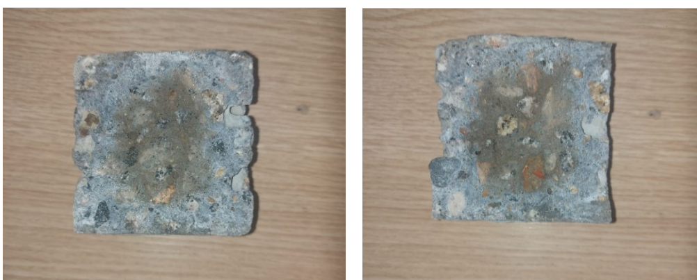
Figura L3 – Profundidades de penetração de cloretos para as amostras 4CL1 e 4CL2
