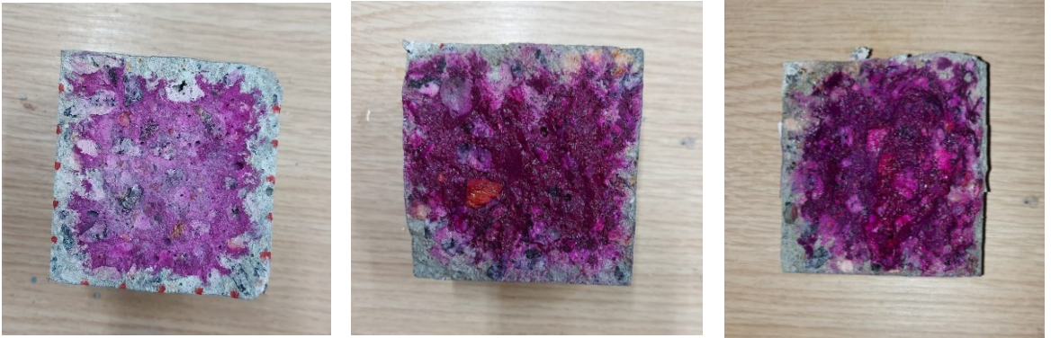
Figura M12 – Profundidades de carbonatação para a amostra 5AC2 ao final do 5º, 9º e 12º ciclos
