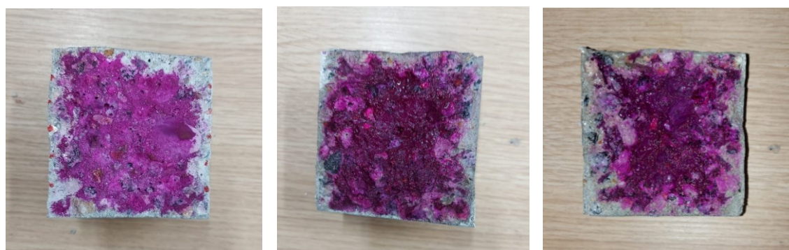
Figura M11 – Profundidades de carbonatação para a amostra 5AC1 ao final do 5º, 9º e 12º ciclos
