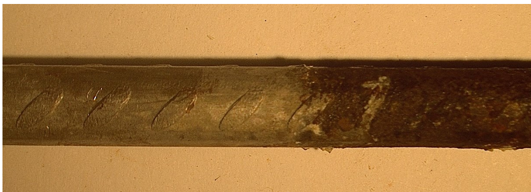
Figura 56 - Área previamente pintada para limitação de superfície exposta à corrosão
