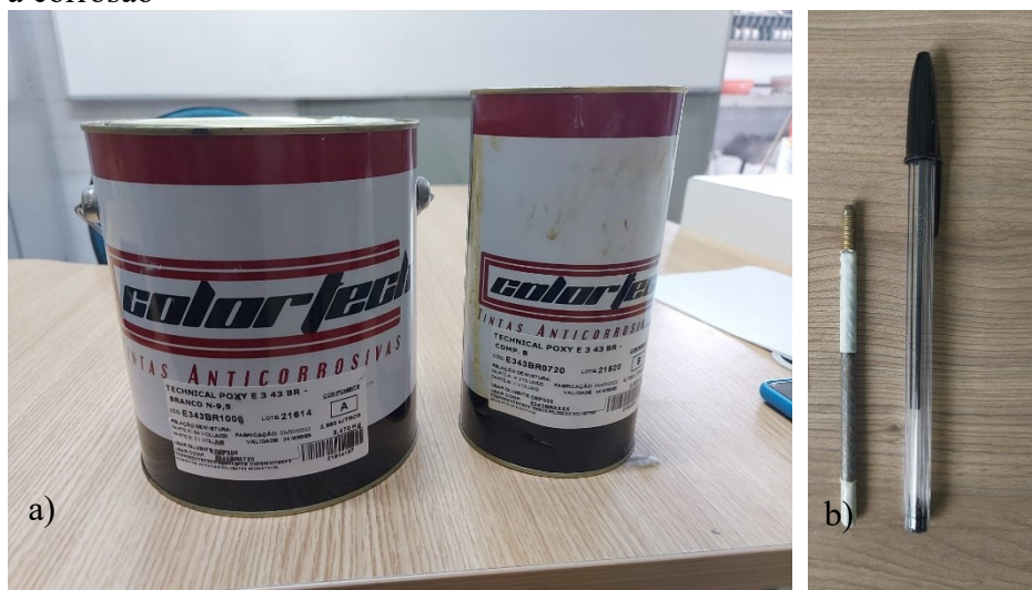
Figura 16 – Tinta anticorrosiva utilizada para delimitação da área sujeita à corrosão
