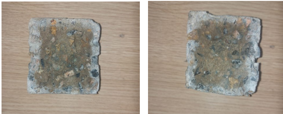
Figura L1 – Profundidades de penetração de cloretos para as amostras 3CL1 e 3CL2
