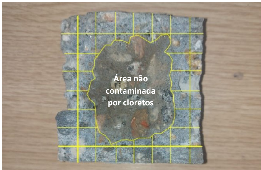
Figura 32 – Corpo de prova analisado para determinação da profundidade de penetração de cloretos
