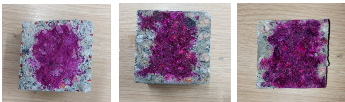
Figura M10 – Profundidades de carbonatação para a amostra 5CO2 ao final do 5º, 9º e 12º ciclos
