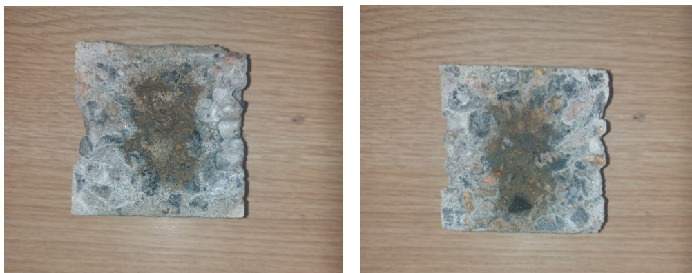
Figura L2 – Profundidades de penetração de cloretos para as amostras 3AC1 e 3AC2
