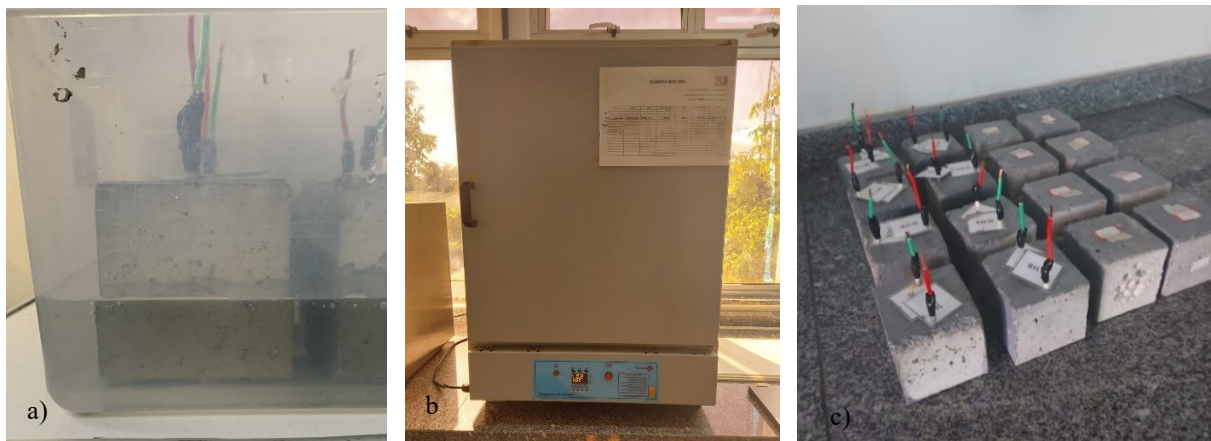
Figura 20 - Ensaio acelerado de corrosão induzida por cloretos
