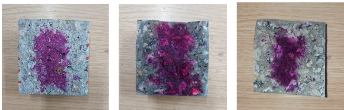
Figura M6 – Profundidades de carbonatação para a amostra 4CO2 ao final do 5º, 9º e 12º ciclos
