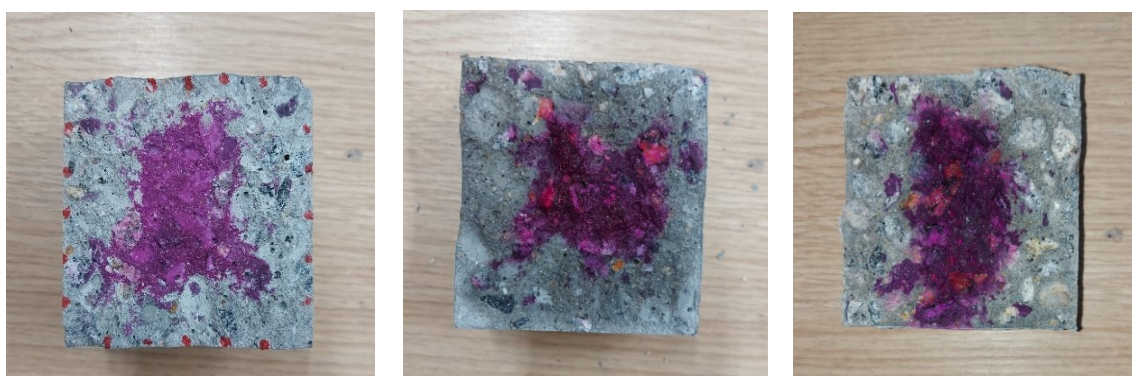
Figura M5 – Profundidades de carbonatação para a amostra 4CO1 ao final do 5º, 9º e 12º ciclos
