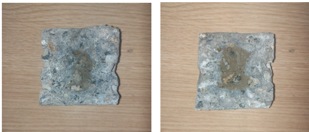
Figura L4 – Profundidades de penetração de cloretos para as amostras 4AC1 e 4AC2
