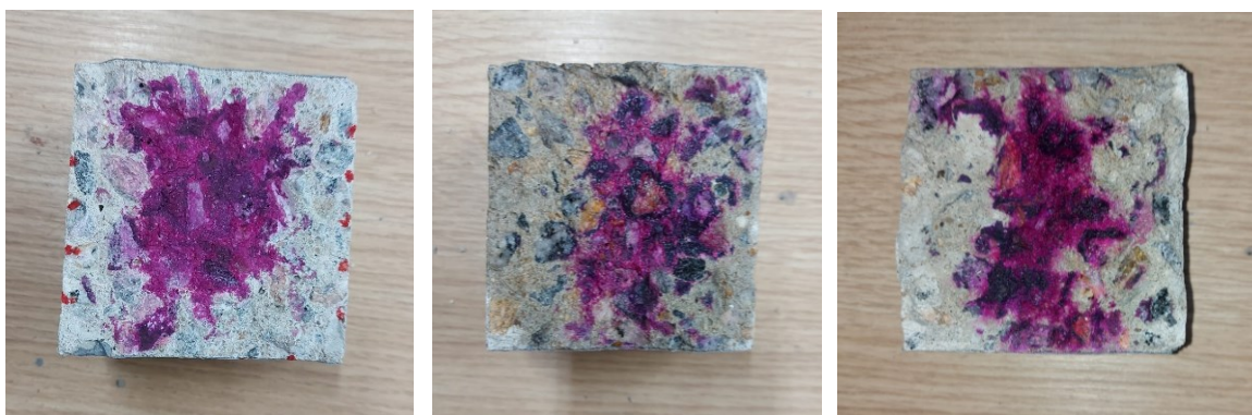
Figura M2 – Profundidades de carbonatação para a amostra 3CO2 ao final do 5º, 9º e 12º ciclos
