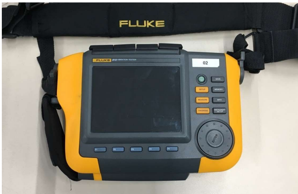
Figura 26 - Analisador de espectro usado durante as inspeções.
