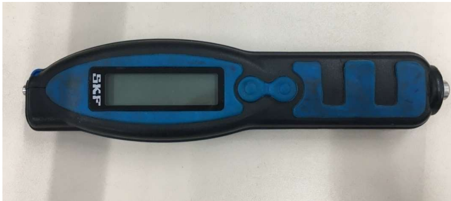
Figura 24- Caneta de vibração utilizada durante as inspeções.
