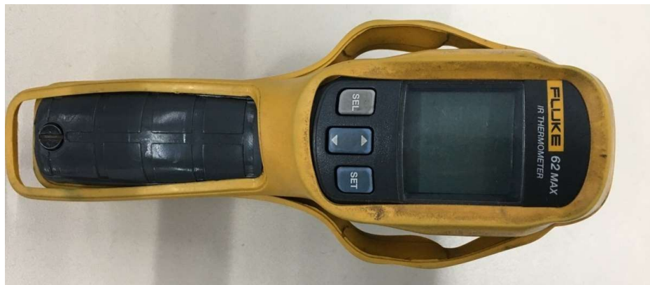
Figura 25 - Pirômetro utilizado nas inspeções
