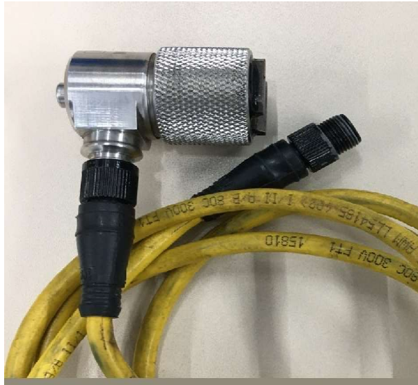
Figura 27 – Sensor triaxial que faz coleta de dados no domínio da frequência.
