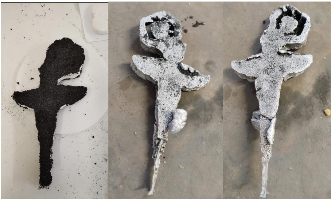
Figura 21: Modelo e produto produzido a partir do revestimento refratário usando as proporções 70 g de alumina 60 mesh + 10 g de silicato + 20 g de água.
