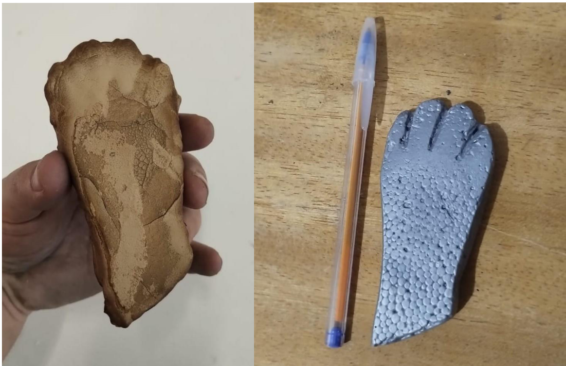
Figura 26: Produto produzido a partir do recobrimento refratário usando as proporções 70 g de areia 60 mesh + 3 g de silicato + 30 g de água.
