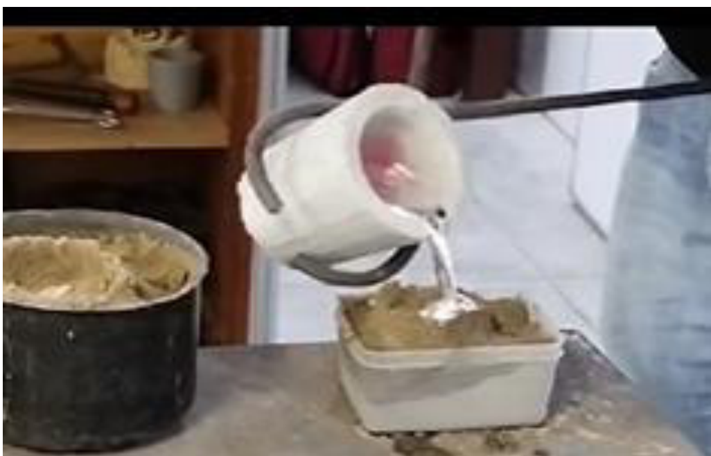
Figura 8: Vazamento do alumínio.
