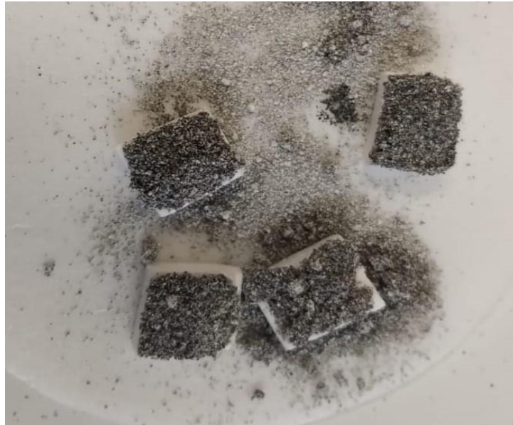
Figura 23: Modelo produzido a partir do recobrimento refratário usando as proporções 70 g de alumina 60 mesh + 10 g de silicato + 20 g de água + 30g gesso + 5 g amido.
