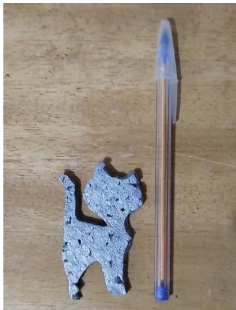
Figura 9: Gato produzido por processo de Fundição de espuma-perdida.
