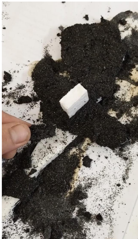
Figura 24: Modelo produzido a partir do recobrimento refratário usando as proporções 50 g de alumina 60 mesh + 5 g de silicato + 15 g de água + 0,1g surfactante.
