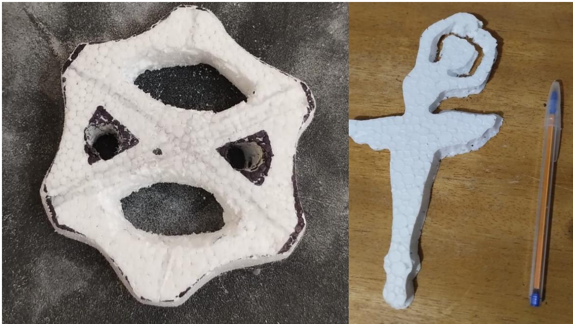
Figura 6: Modelo de poliestireno expandido da manopla e bailarina para revestimento de casca.
