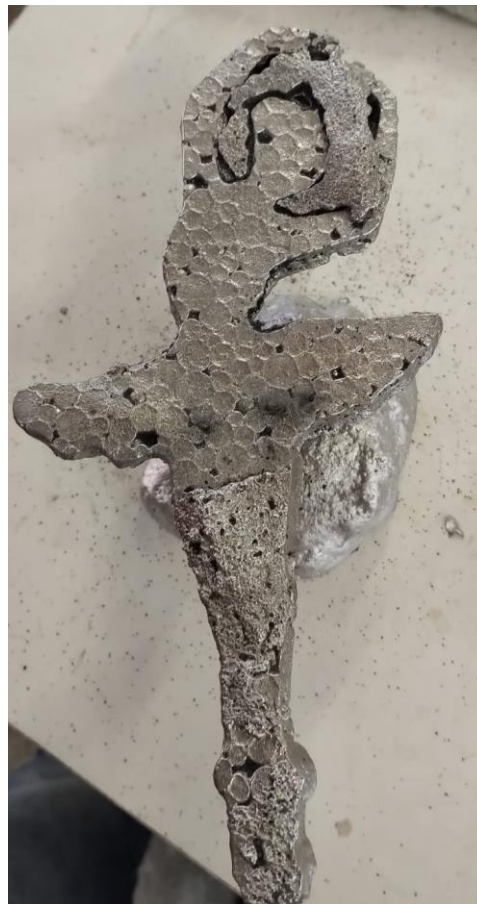
Figura 25: Produto produzido a partir do recobrimento refratário usando as proporções 50 g de alumina 60 mesh + 5 g de silicato + 15 g de água.
