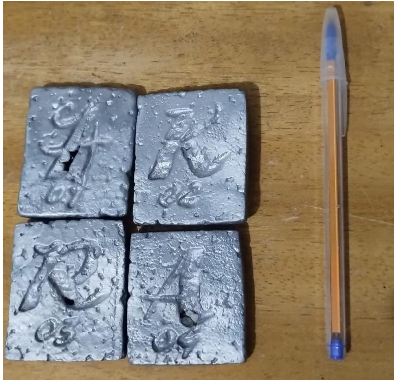
Figura 14: Resultado após o vazamento.
