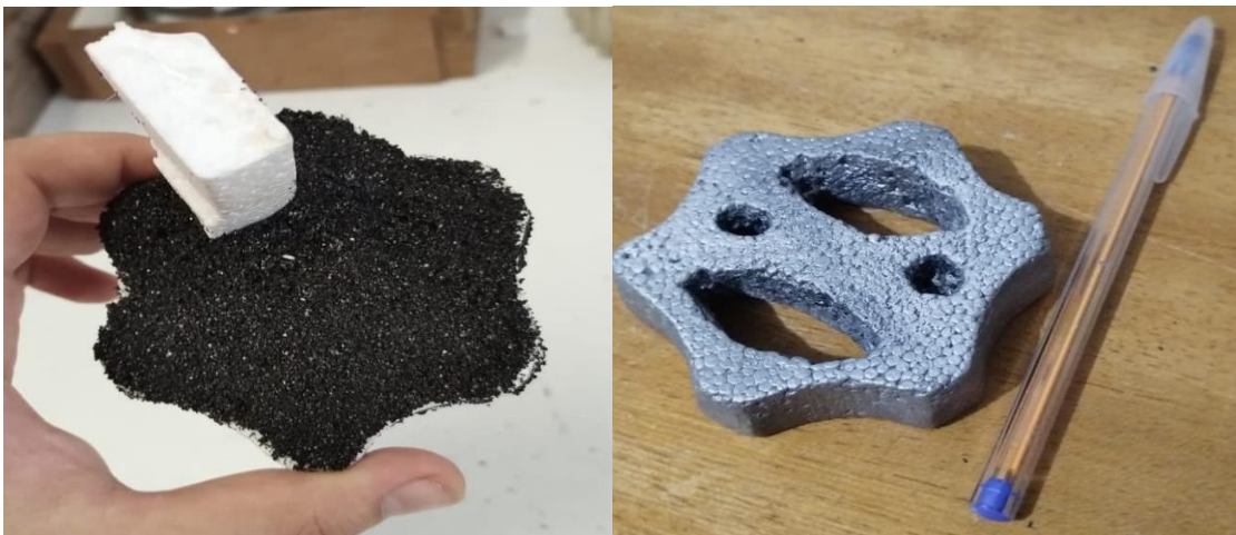
Figura 20: Molde e resultado da manopla solicitada pelo laboratório.
