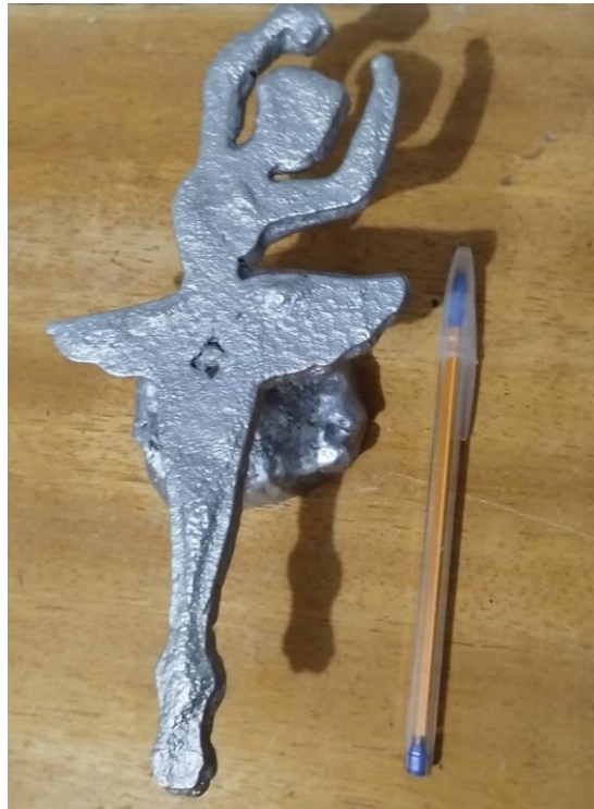
Figura 11: Protótipo da bailarina sem revestimento alimentada pelo centro.
