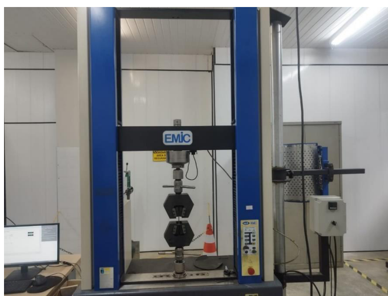
Figura 18 - Máquina de Ensaios EMIC DL-10000.
