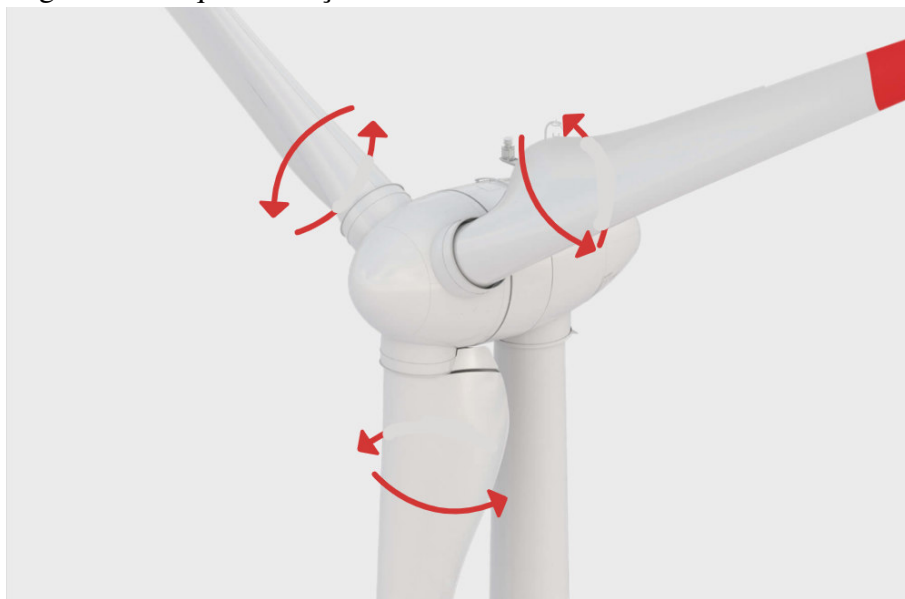
Figura 7 – Esquemática do sistema de controle de Pitch
