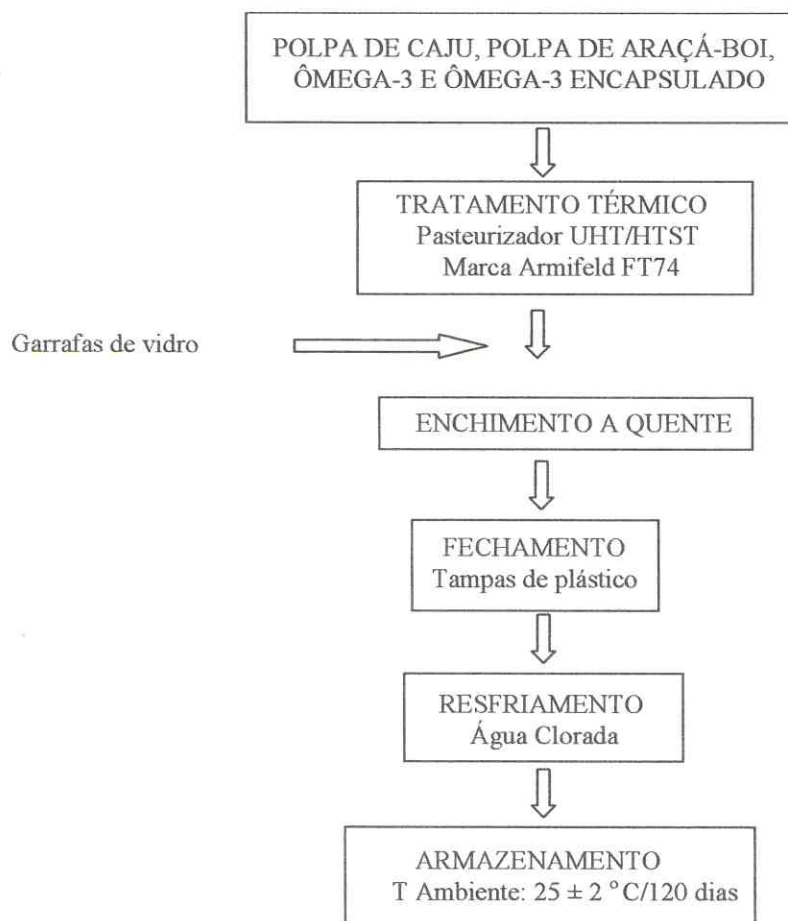
Figura 11 - Fluxograma de preparação das bebidas formuladas com caju e araçá-boi e ômega-3.
