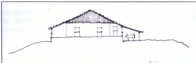
Figura 4.2. G: Vista e Corte da fazenda pertencente ao Sr. Manuel Inácio, veja o detalhe do duplo alpendre. (croqui baseado em desenhos de Clewton Nascimento)
