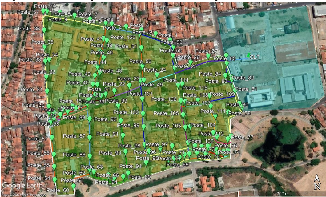
Figura 38 – Postes mapeados através da latitude e longitude.
