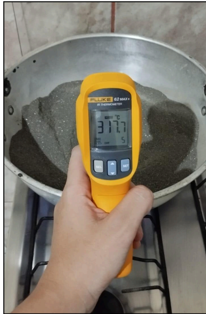
Figura 25 - Ataque térmico na rocha
