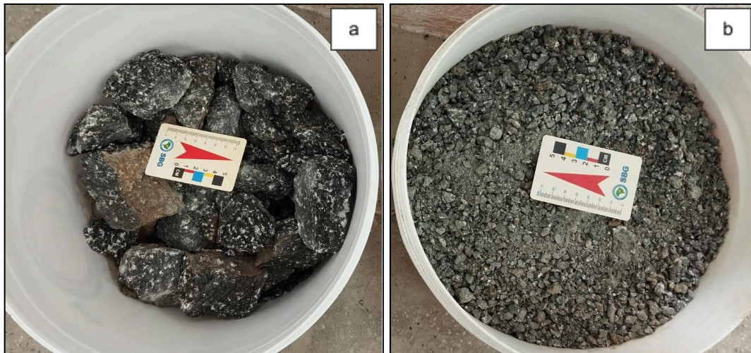
Figura 20 - Material submetido ao processo de britagem (a) material pós fragmentação; (b) material pós britagem
