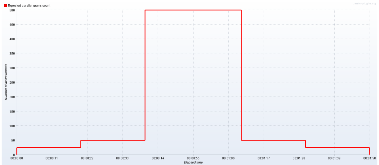
Figura 36 – Modelagem do teste de pico
