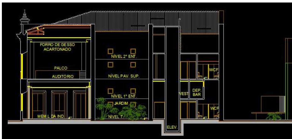
Figura 174. Corte transversal mostrando elevador, os entrepisos, espaços de apoio, auditório e memorial. Fonte: acervo pessoal do arquiteto Domingos Linheiro.
