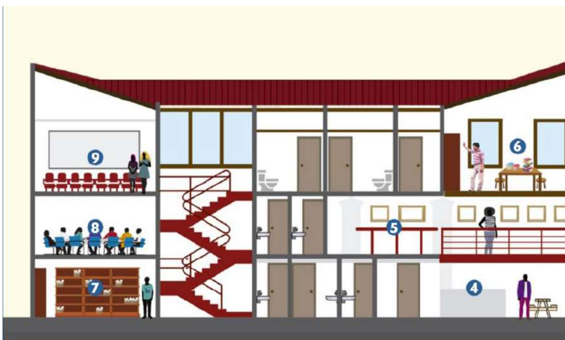
Figura 150. Imagem de corte longitudinal mostrando o bloco de apoio, a nova escada, os novos banheiros e a altura dos níveis. Legenda: 4. Espaço Café do Zé; 5. Mezanino; 6. Biblioteca; 7. Depósito; 8. Administrativo; 9. Auditório. Fonte: Cartilha Percursos Históricos: conhecendo o Sobrado Dr. José Lourenço. Ver em: https://issuu.com/sobrado154/docs/cartilha_sobrado_-_vers_o_virtual_final .
