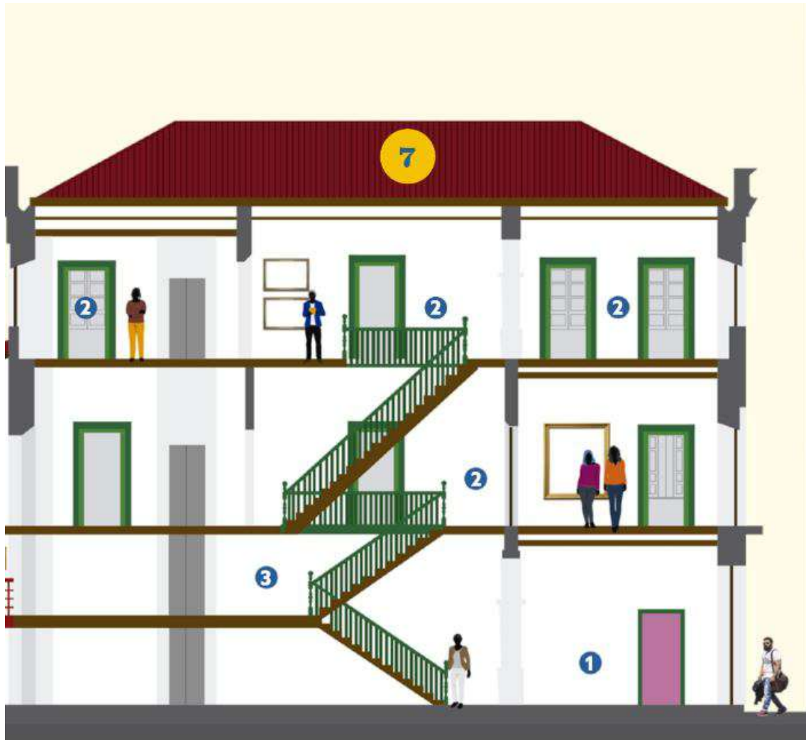
Figura 149. Imagem de corte longitudinal mostrando o bloco principal. À esquerda, o novo elevador com acesso aos três níveis e no centro, a antiga escada. Legenda : 1. Entrada; 2. Espaço expositivo; 3. Hall mezanino; 4. Espaço café do Zé; Fonte: Cartilha Percursos Históricos: conhecendo o Sobrado Dr. José Lourenço.
