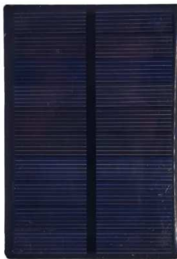
Figura 10 – Placa solar utilizada como sensor do piranômetro
