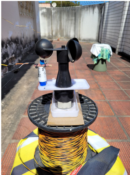
Figura 7 – Estrutura completa do anemômetro, com o sensor, carcaça e ímãs
