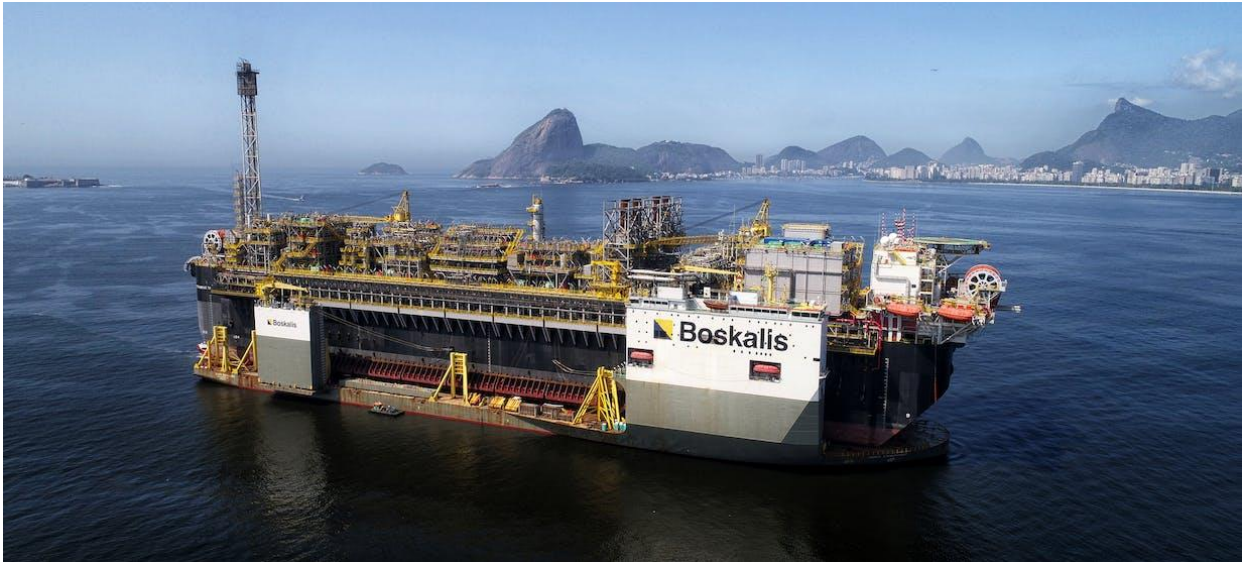
Figura 5 – FPSO P-70 sendo rebocada por sistema de dry tow pela BOKA VANGUARD, da BOSKALIS.
