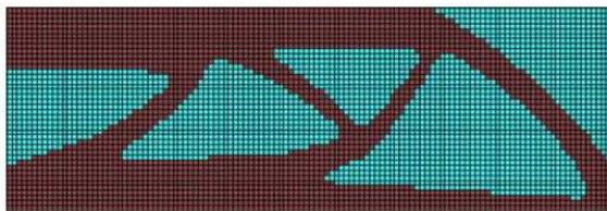
Figura 8 – Resultado obtido por Huang e Xie (2009) para a parte simétrica de uma viga aplicando uma força pontual em baixo.
