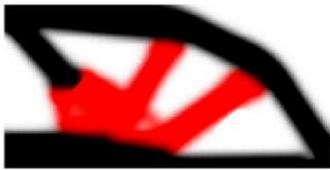
Figura 7 – Resultado obtido por Lieu e Lee (2017) para a parte simétrica de uma viga aplicando uma força pontual em cima.
