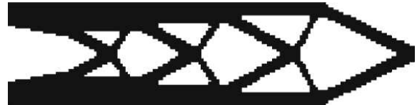
Figura 2 – Comparação dos resultados com o SIMP e BESO para o problema de uma viga em balanço longa.
