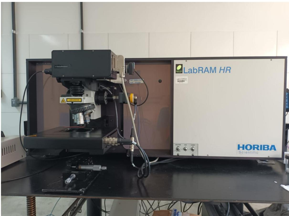
Figura 5. Espectrômetro Raman utilizado para as análises químicas.
