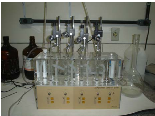
Figura 15 - tiras de corpos cavernosos em sistema de banhos isolados.
