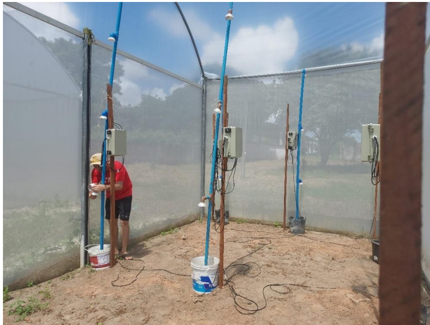
Figura 17: Distribuição e fixação das estações de coletas de dados na Estufa com Filme Transparente
