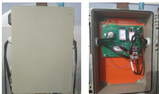
Figura 10: Caixa protetora utilizada para proteção da placa de circuitos
