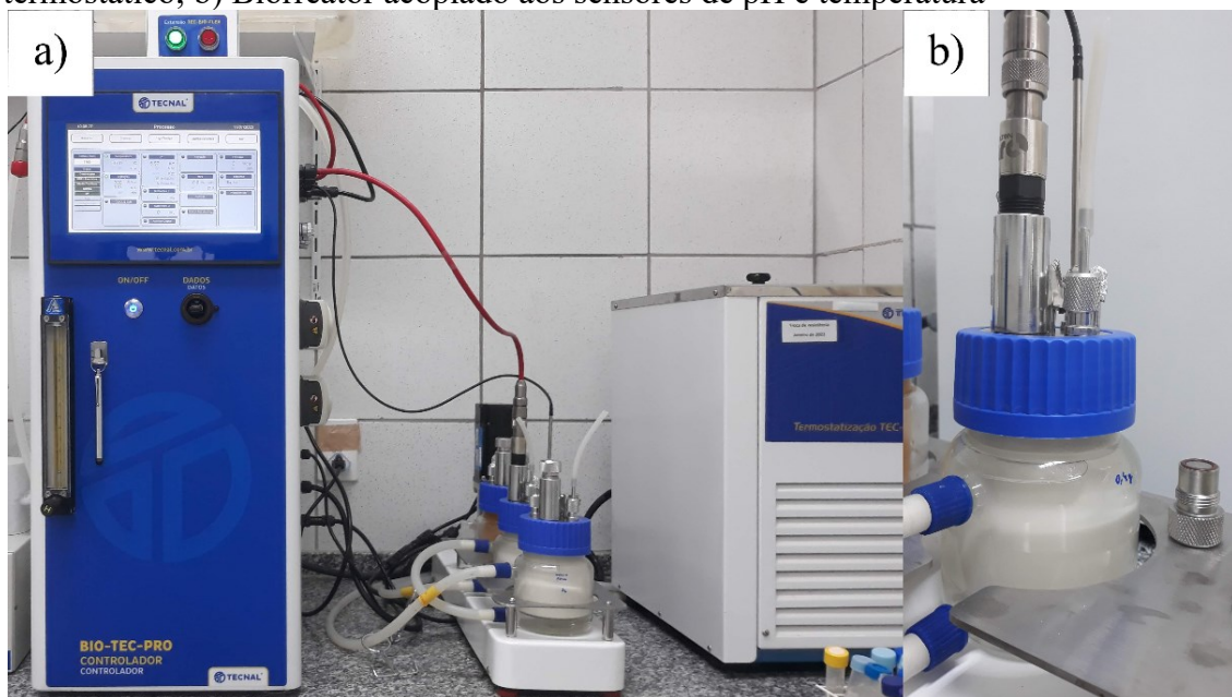
Figura 7 – Biorreator BIO-TEC-PRO. a) Sistema de biorreatores, controlador e banho termostático; b) Biorreator acoplado aos sensores de pH e temperatura
