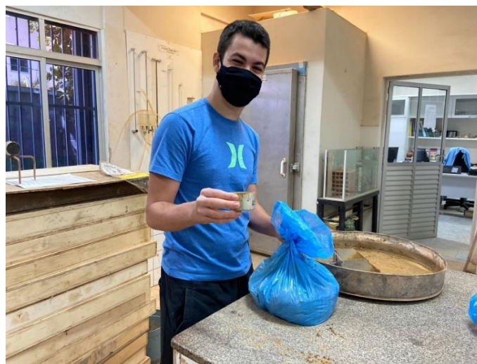
Figura 21- Etapa de isolamento, homogeneização de solo e retirada de frações para conferência de umidade.
