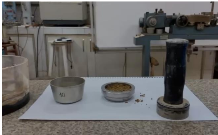
Figura 24 – Compactação do solo em escala reduzida.
