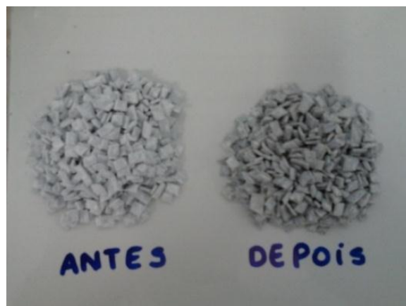
Figura 19 – Cobertura do dióxido de titânio em alumínio antes e depois das corridas no reator.
