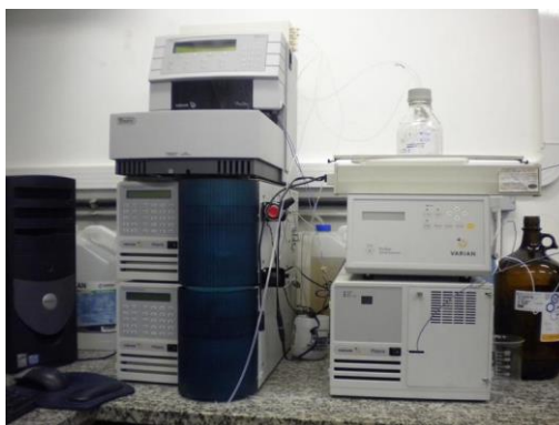
Figura 19: Cromatógrafo Líquido de Alta Eficiência (Varian, modelo 450 CG).
