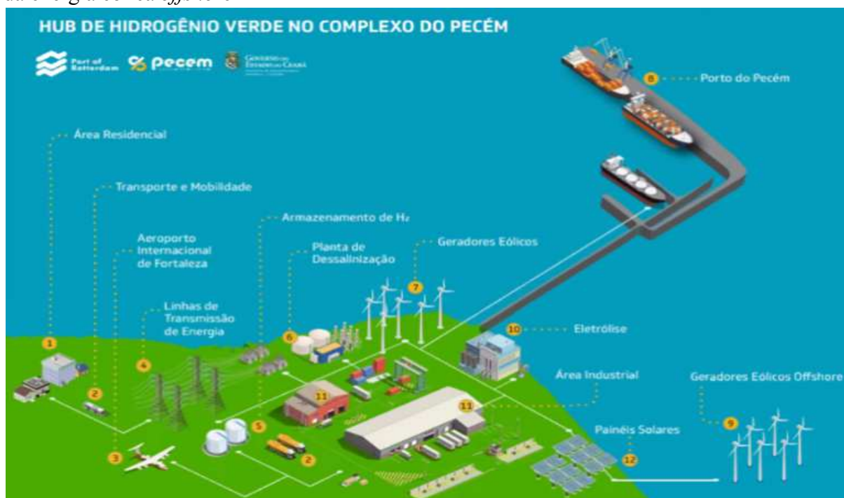
Figura 15- Projeto do hub de hidrogênio verde no Complexo do Pecém com previsão de uso da energia eólica offshore
