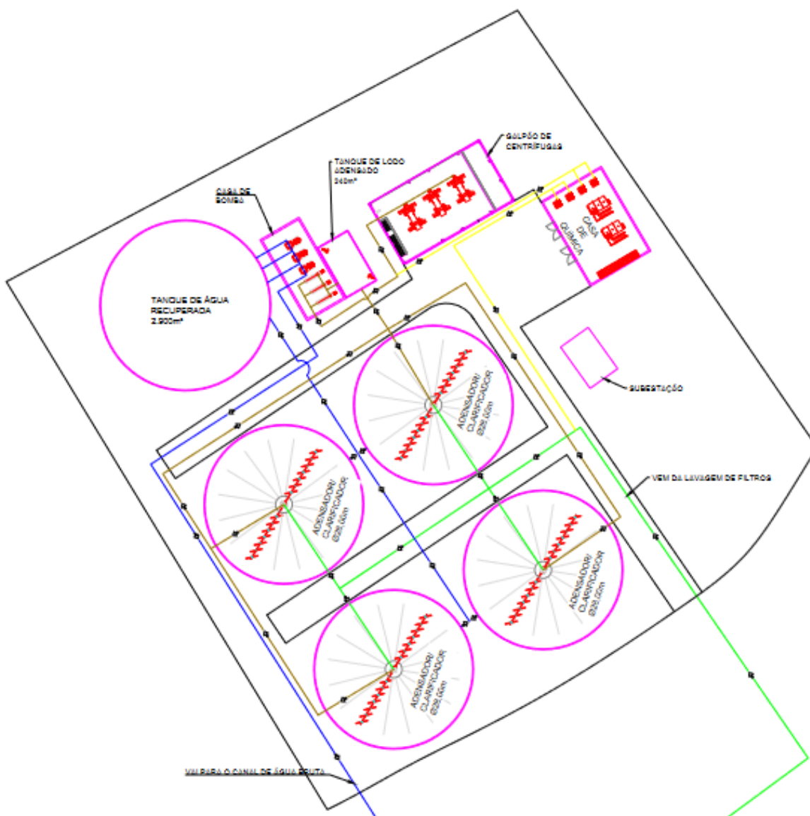
Figura 3 - Configuração da ETRG com Decantadores
